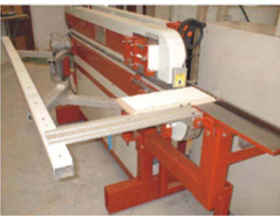
La fresadora-lijadora de cantos moldurados es una máquina para grandes producciones, que reduce en gran medida los tiempos de trabajo al no tener que moldurar y lijar en diferentes máquinas con el consecuente ahorro en tiempos y costes.
