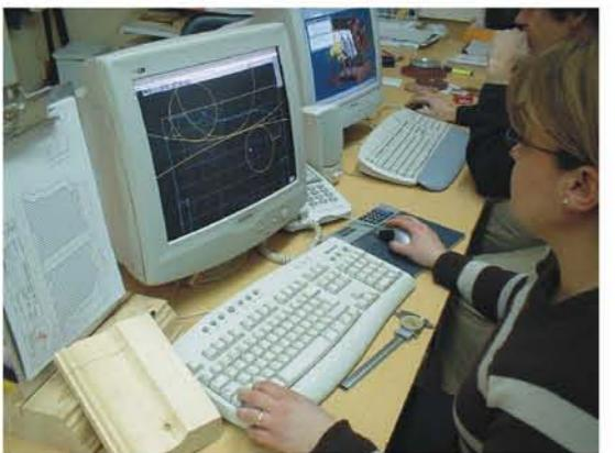
При получении образцов техническим отделом, эскиз профиля цифруется. После этого, вся необходимая информация отсылается в различные производственные подразделения с современными компьютерными системами, контролирующими как процессы обработки, так и качество продукции.
